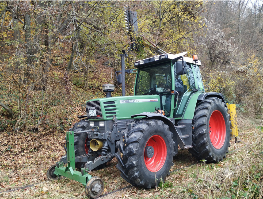
Zweiwege-Gefährt mit Astschere an Ausleger
